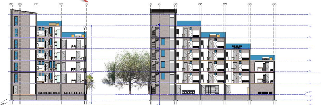
Op de doorsneden zijn duidelijk de beukmaten te zien. Elke woning is 6 meter breed en afhankelijk van of het een twee- of eenpersoonswoning is heeft de woning een lengte van 4 of 6 meter. De indeling is erg open wat zorgt voor een nog vrije indeelbaarheid.
