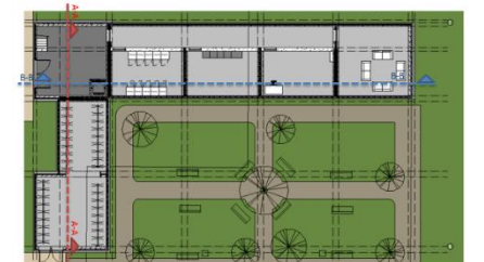
Op de doorsneden zijn duidelijk de beukmaten te zien. Elke woning is 6 meter breed en afhankelijk van of het een twee- of eenpersoonswoning is heeft de woning een lengte van 4 of 6 meter. De indeling is erg open wat zorgt voor een nog vrije indeelbaarheid.
