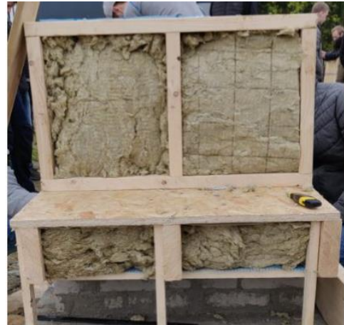
figuur 4.4.2 Goede isolatie vloer, verkeerde isolatie gevel
