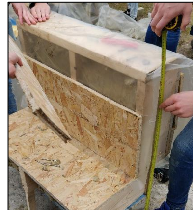
figuur 4.3.9 Remmende folie warme kant en OSB-afwerking
