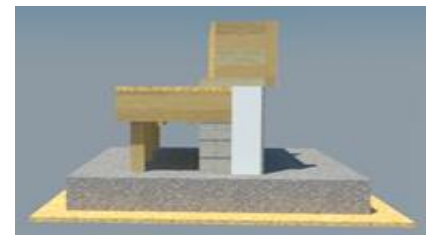
Figuur 3.3.4 Vloer constructie met gevel zonder bekleding
