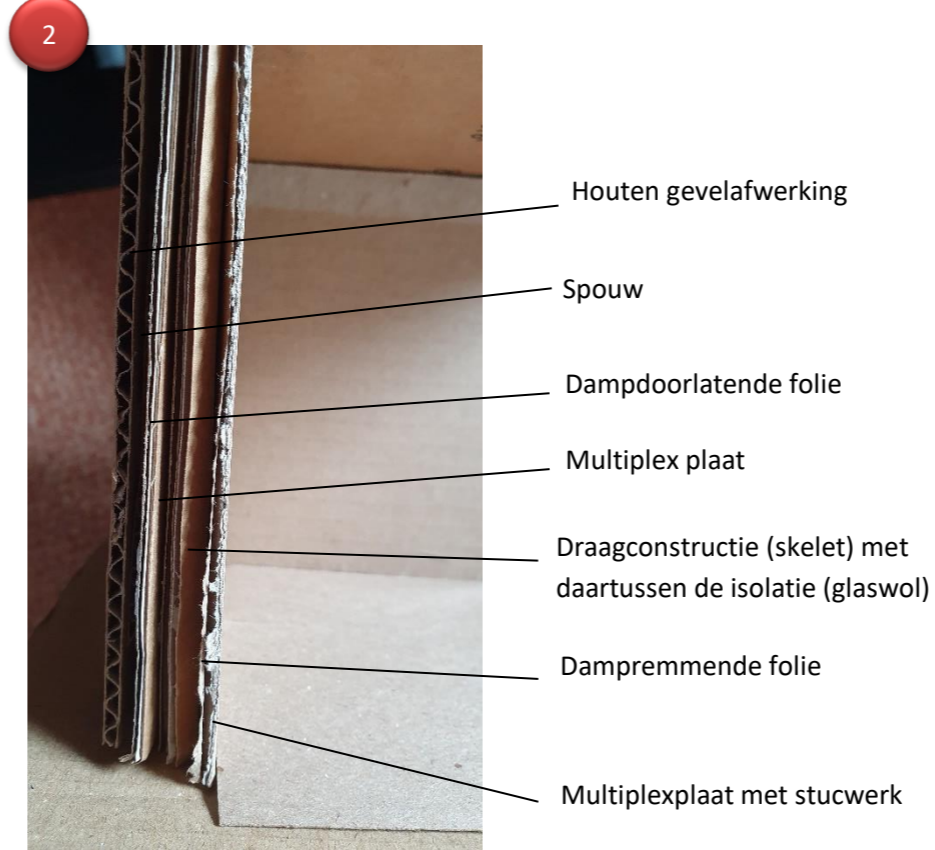
Figuur 2: Gevelopbouw
